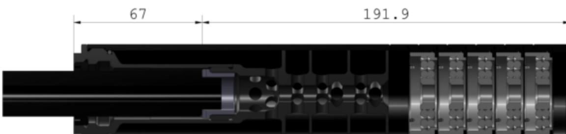
Jedes weitere Dämpfungselement ( Sintereinsatzhalter und Sintereinsatz) beträgt **35 Gramm** und verlängert den Schalldämpfer um 15 mm ( 1,5 cm )
